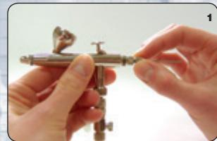
**Gründliche Reinigung (vor längeren Arbeitspausen):** 1. Druckluftzufuhr beenden. Endstück (K) und Nadelklemmmutter (J) abschrauben.
