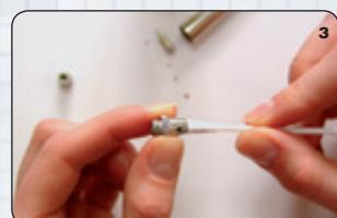
**3.** Luftkopf (A) abschrauben und mit einem Wattestäbchen reinigen.
