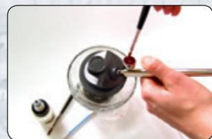
**Zwischenreinigung:** Farbe ausspritzen, Reste mit Wasser und/oder geeignetem Reinigungsmittel und Pinsel/Wattestäbchen lösen und ausspritzen.
