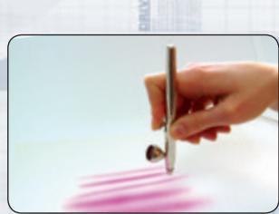
**Breite Linie/Verlauf:** Hebel in der Bewegung weiter nach hinten ziehen, zügig bewegen. Am Ende das Gerät absetzen und in Gegenrichtung sprühen.
