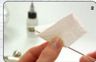
**2.** Nadel (H) herausziehen, mit einem Tuch und Reiniger säubern. Nadelspitze auf Deformierung überprüfen.
