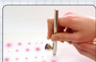
**Sprühpunkte:** 2. Hand zur Stabilisierung benutzen. Mit Luft beginnen, dann Hebel vorsichtig ein wenig nach hinten ziehen. Für größere Punkte mehr Abstand, mehr Farbe.
