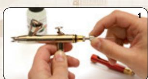
**Grondige reiniging (vóór langere periodes van niet-gebruik):** 1. De persluchtoevoer uitschakelen. Het eindstuk (L) en de naaldklemmoer (K) losschroeven.
