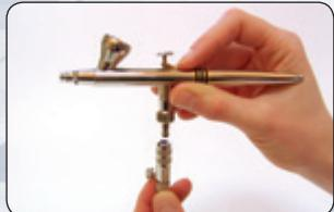
Schließen Sie den Apparat mit Schraubanschluss\* oder Schnellkupplung NW 2,7 mm\* an einen Schlauch\* und eine geeignete Druckluftquelle\* an.
