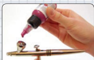
Es sind alle gängigen Airbrush-Farben oder Lacke geeignet, die eine milchähnliche Konsistenz haben. Die Farbe ist ggf. entsprechend zu verdünnen. Die Geräte der Evolution Silverline-Serie sind speziell für die Verwendung von lösemittelhaltigen Produkten konstruiert.
