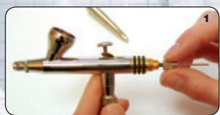
**Gründliche Reinigung (vor längeren Arbeitspausen):** 1. Druckluftzufuhr beenden. Endstück (L) und Nadelklemmutter (K) abschrauben. Besondere Vorsicht ist im Umgang mit der Nadel geboten, es besteht Gefahr von Stichverletzungen.
