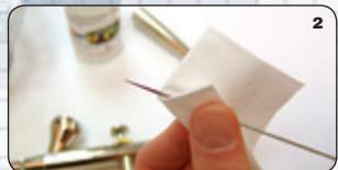
**Nettoyage approfondi (avant toute pause d'utilisation prolongée):** 1. Stopper l'arrivée d'air comprimé. Dévisser la queue (L) et le contre-écrou de l'aiguille (K).
