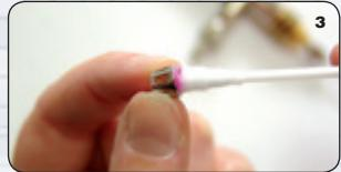
3. Nadelkappe (A) abschrauben und mit einem Wattestäbchen reinigen.
