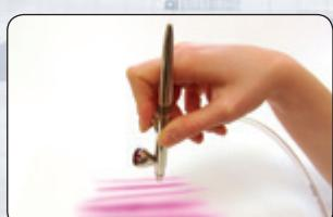
**Breite Linie/Verlauf:** Hebel in der Bewegung weiter nach hinten ziehen, zügig bewegen. Am Ende das Gerät absetzen und in Gegenrichtung sprühen.
