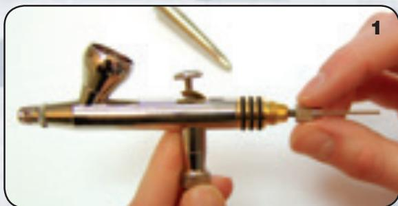
**Grondige reiniging (vóór langere periodes van niet-gebruik):** 1. De persluchttoevoer uitschakelen. Het eindstuk (L) en de naaldklemmoer (K) losschroeven.
