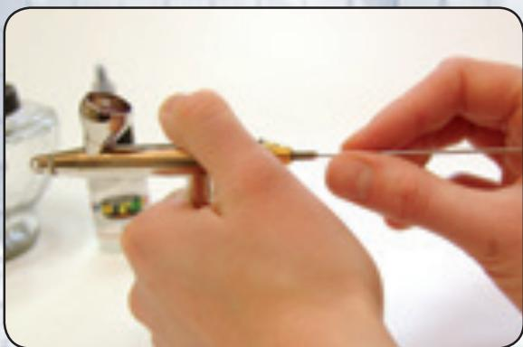
**5.** Het spuitstuk (C) wegnemen en met een fijn penseel of de naald (I) verfresten voorzichtig uit de binnenkant verwijderen. De sproeikop en afdichting op scheuren en vervorming controleren.
